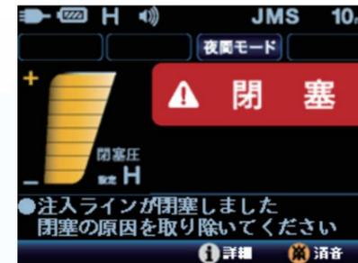
シリンジの装着状態、閉塞モニタを一目で確認。警報発生時の内容・操作を表示。
