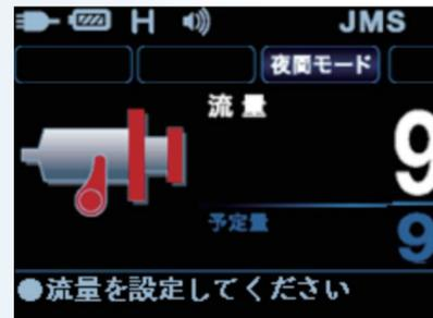
流量、予定量、積算量の各表示は色、大きさで区別。シリンジの装着状態を表示。
