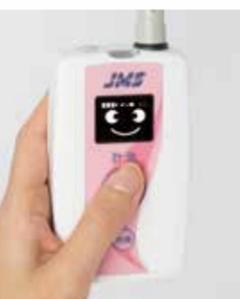
わずか135gと軽量の本体にリチウムイオン充電電池を内蔵し、バッテリー駆動可能
