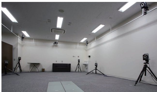
8枚のフォースプレートを囲む17台の赤外線カメラ
