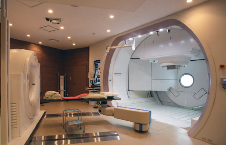
回転ガントリ照射装置を有した陽子線治療室
